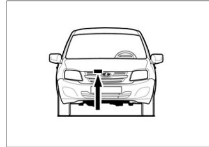
Fig. 23. Protective hook tab
