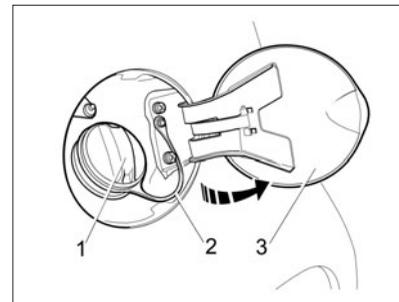
**Fig. 27. Fuel tank plug**
