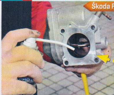
Škrtky klapky lze snadno demontovat a vyčistit. Přidejte si to do servisního plánu.
