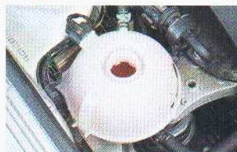
Když je chladicí kapalina takto čistá, nemůže být o vadném těsnění pod hlavou ani řeč. Varující by byl hnědý povlak na stěnách expanzní nádoby.
