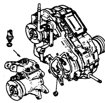
Отсоединить клемму датчика, снять рычаг переключения блокировки
