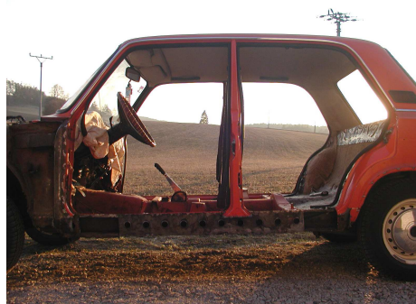
I prahová výztuha částečně zasažena
