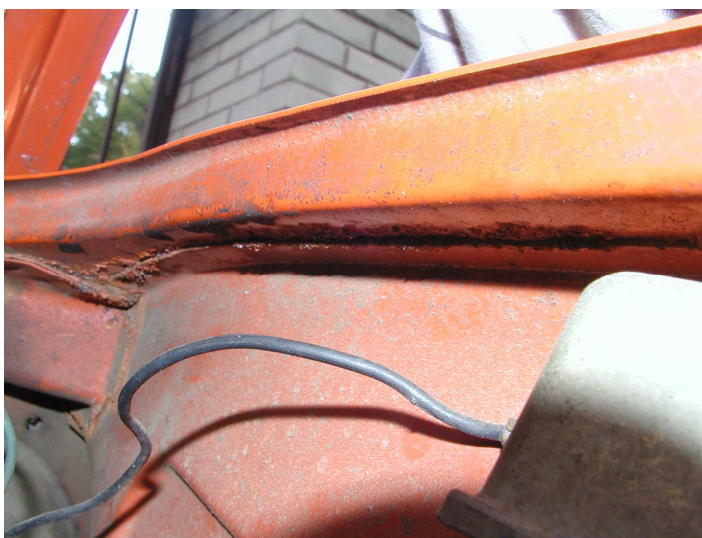
Spoj blatníku a podběhu = koroze leze z vnitřní strany, z podběhu
