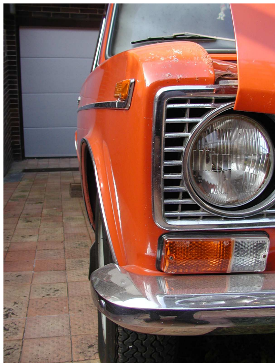
Nabobtnaný blatník = koroze leze z vnitřní strany, z podběhu
